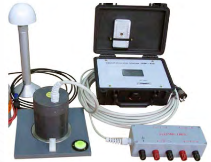
आकृति 3. LMT उपकरण जहां जीपीएस यूनिट के साथ एक फ्लक्सगेट सेंसर द्वारा चुंबकीय क्षेत्र परिवर्तन दर्ज किए जाते हैं। LMT में इलेक्ट्रोड वही हैं जो MT में उपयोग किए जाते हैं। डेटा 1-30000 s से दर्ज किया गया है।
