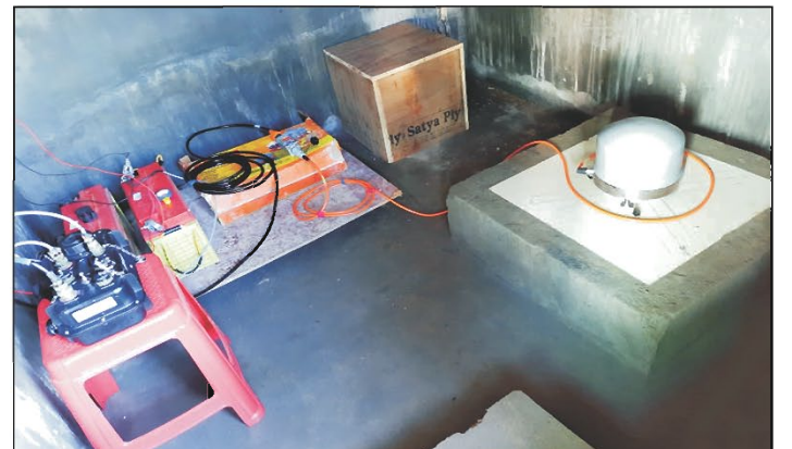
वर्षा वन अनुसंधान संस्थान (RFRI) परिसर, जोरहाट, असम में नए ब्रॉडबैंड सीस्मोग्राफ (BBS) की स्थापना।
