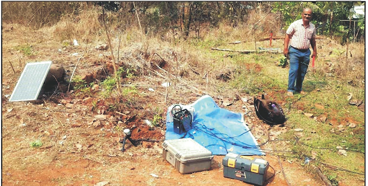
राजापुर भू-तापीय क्षेत्र, पश्चिमी महाराष्ट्र, भारत के पास स्थित एएमटी स्टेशनों का क्षेत्र सर्वेक्षण।
